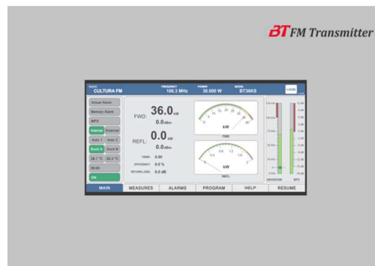
Figura 3: Apresentação do Painel de controle e Status do Equipamento
