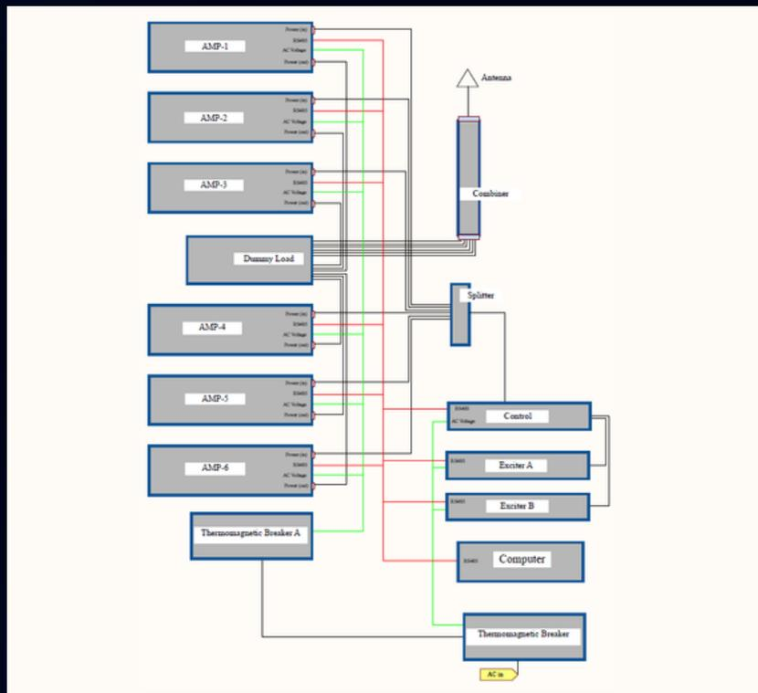
Formado por seis amplificadores de 3.500W combinados, fornecem mais de 18.000W em sua saída operando sincronizados pelos módulos de controle que geram o sinal de RF de baixa potência para cada amplificador.
